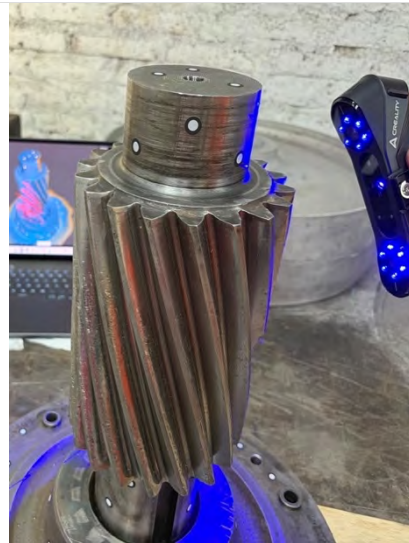
Ingeniería inversa — Escaneo 3D y CAD
