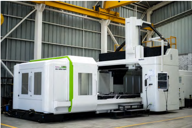
Hartford HSA-528EA — centro de mecanizado de 20 toneladas de capacidad
