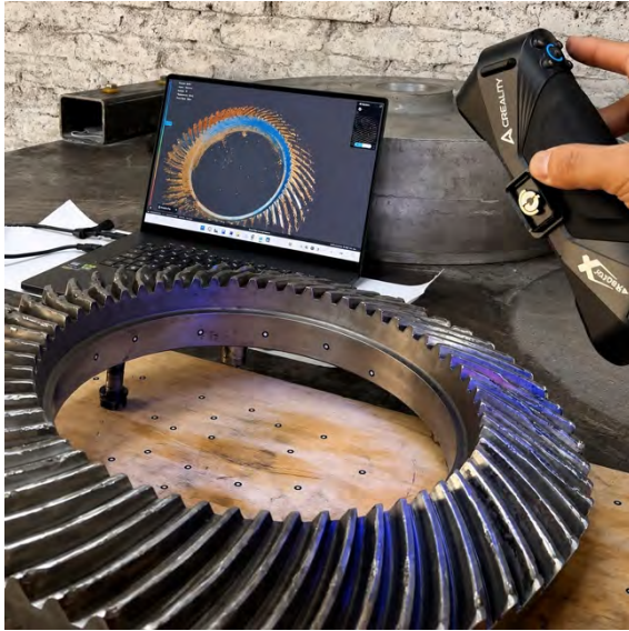
Escaneo 3D con Creaform Scan — Ingeniería inversa
