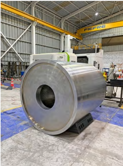
Fabricación de componente grande — Polea Ø1600 × 1800 mm
