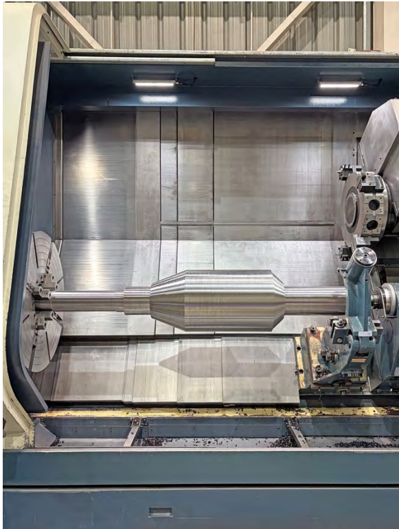
Fabricación de un eje de rotor
