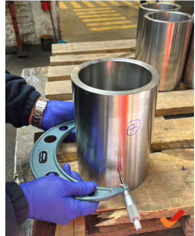
Inspección con micrómetro Mitutoyo
