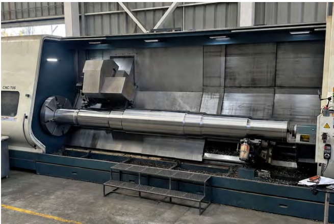
Torno CNC Johnford ST-240 CH — eje de 5.300 mm en producción
