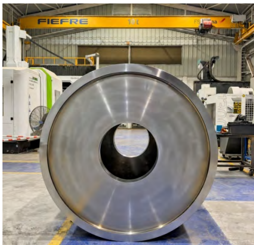
Taller FS Roma — Polea Ø1600 mm con centro de mecanizado CNC Hartford
